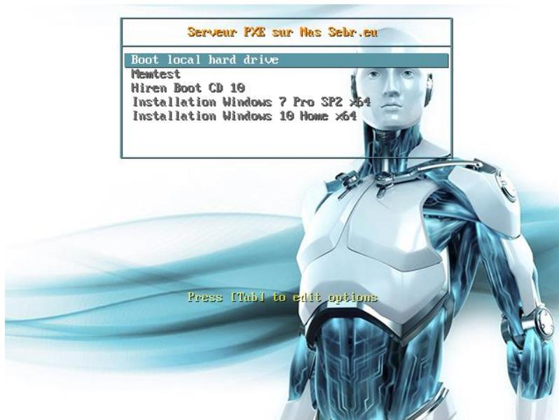
L'amorçage PXE (sigle de Pre-boot eXecution Environment) permet à une station de travail de démarrer depuis le réseau en récupérant une image de système d'exploitation qui se trouve sur un serveur; en l'occurrence un serveur de fichiers géré par le NAS.
